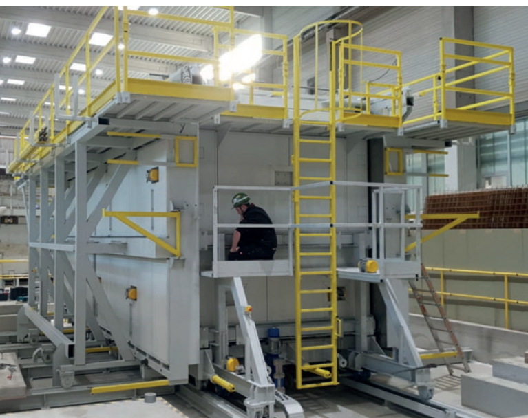
Vue d'ensemble du moule variable pour cabines
